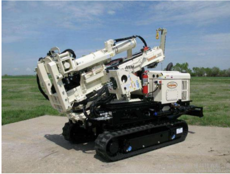
图 5.2.1-1 7822DT 型 Geoprobe 钻机
