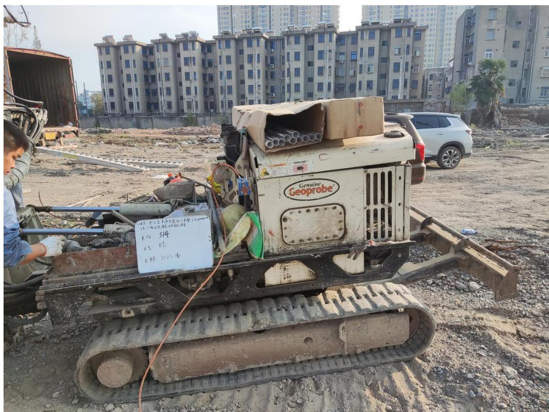
图 6.2-1 7822DT 型 Geoprobe 钻机
